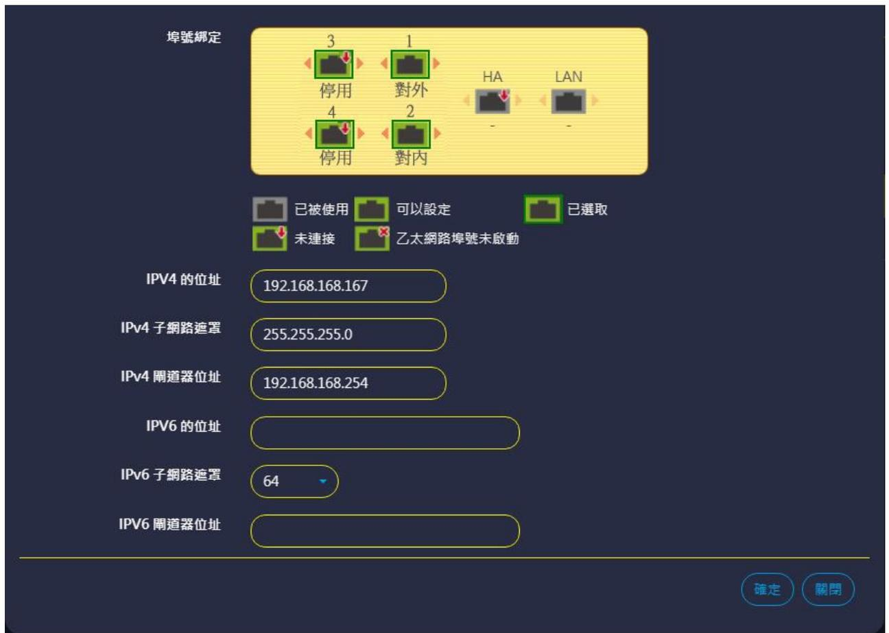
圖 2-6、透通模式的 Port 及 IPV4 位址設定
